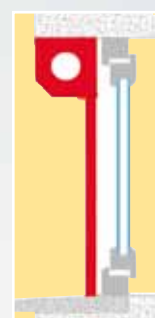
Pose enroulement extérieur
